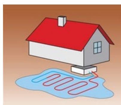
Tepelné čerpadlo nemrznoucí kapalina/voda - výměník naplněný nemrznoucí směsí ochlazuje půdu ve vrtu nebo ve výkopu, případně vodu ve vodním toku nebo v rybníku. © EkoWATT
