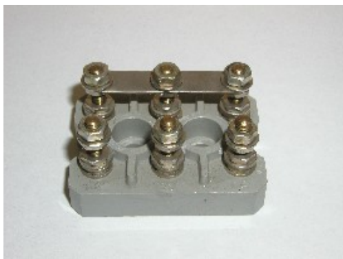
Svorkovnice motoru s propojkami v zapojení do hvězdy
