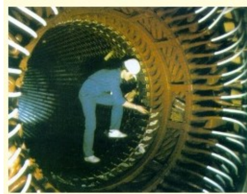
Výroba statoru as. stroje
