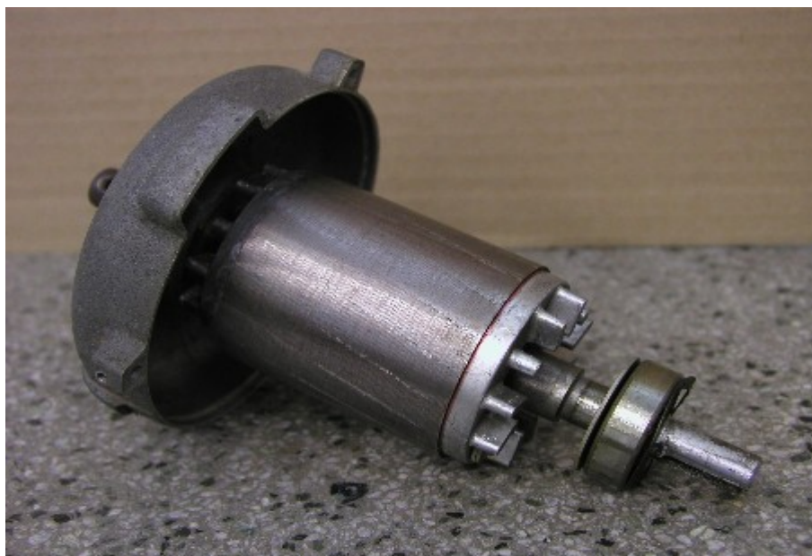
Rotor asynchronního motoru s kotvou nakrátko (vinutí odlité z hliníku)
