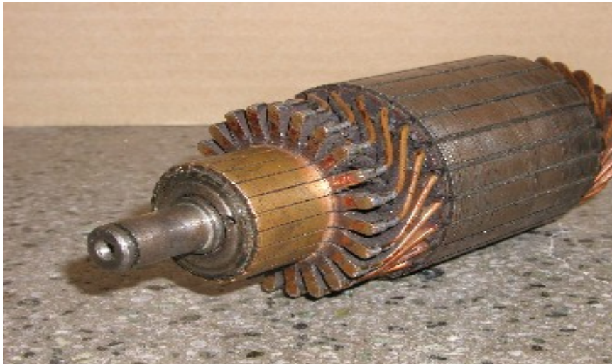
Rotor komutátorového motoru
