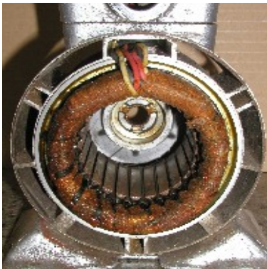
Stator malého 3f. as. motoru
