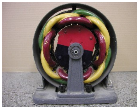
Barevně zvýrazněné cívky motorů (každá fáze má jinou barvu)
