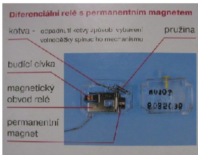
Diferenciální relé proudového chrániče
