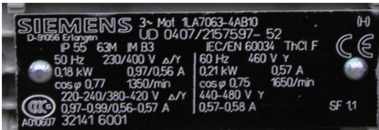
Štítek třífázového asynchronního motoru
