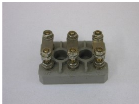
Svorkovnice motoru s propojkami v zapojení do trojúhelníka
