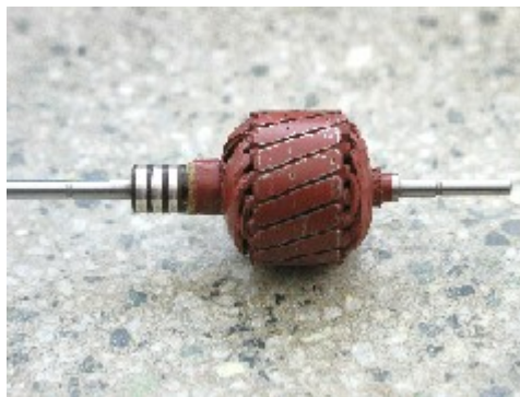
Rotor kroužkového motoru
