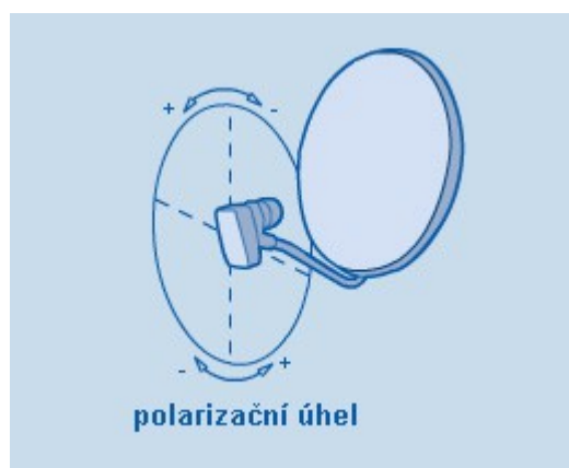
Obr. č. 43 – LNB skew (polarizační úhel) – sklon polarizační roviny (úhel pootočení LNB v držáku)
