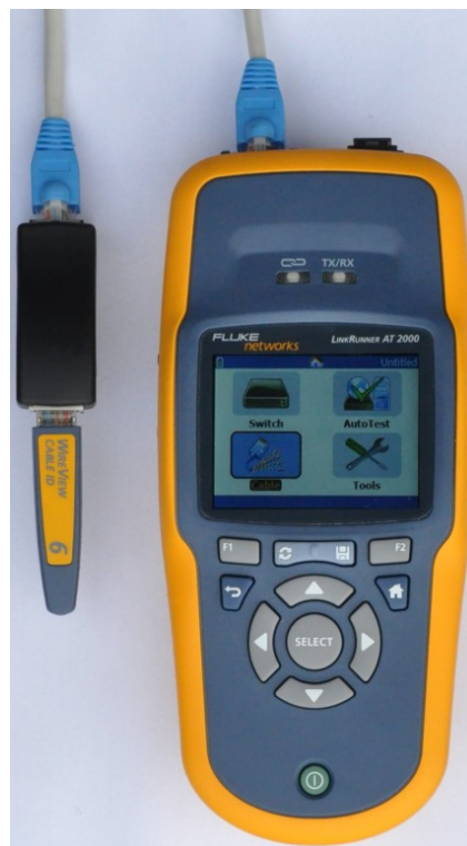
Obr. č. 156 – měření kabelu
