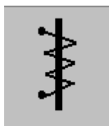
Obr. 46 - Všeobecná značka feromagnetické (elektromagnetické) soustavy
