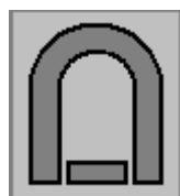
Obr. 40 - Všeobecná značka magnetoelektrické soustavy
