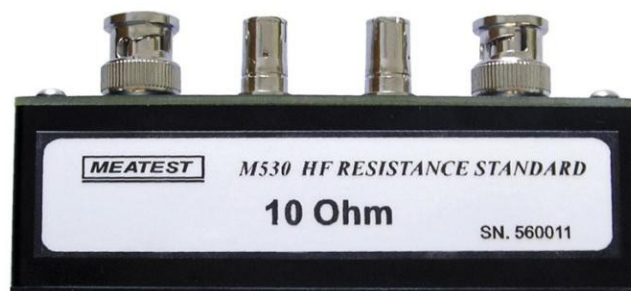
Obr. 6 - Odporový normál pro měření v obvodu střídavého napětí .
