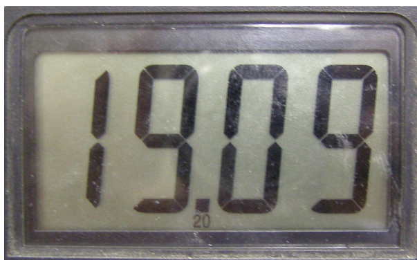
Obr. 67 - Příklad displeje 3 a \frac{1}{2}
