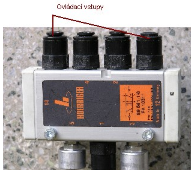
Obr.8.2.1.4.-5/2 ventil, ovládaný pneumatickým signálem, bistabilní
