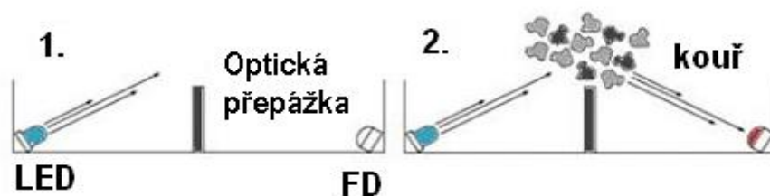
Obr. 5 b) - schéma odklonu paprsku světla
