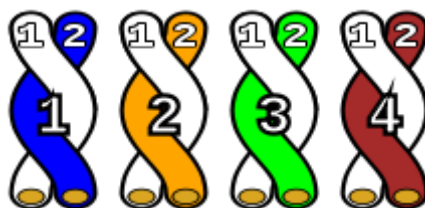
Obr. č. 35 - kroucené dvojlinky uvnitř kabelu
