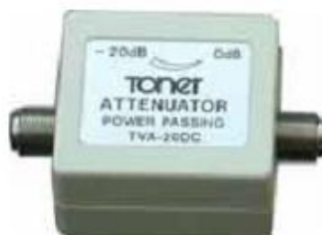
Obr. 13 - proměnný útlumový článek TVA-20 DC fy Toner (průchozí pro napájení) šířka pásma 5 - 2150 MHz, rozsah regulace útlumu 0 - 20 dB průchozí pro DC napájení max. 500 mA.
