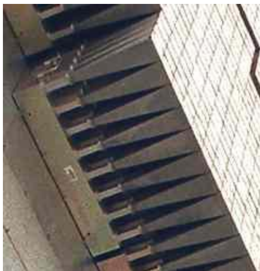
Obr. 6 - detail jednotlivých mikrovlnných zářičů radarové antény.
