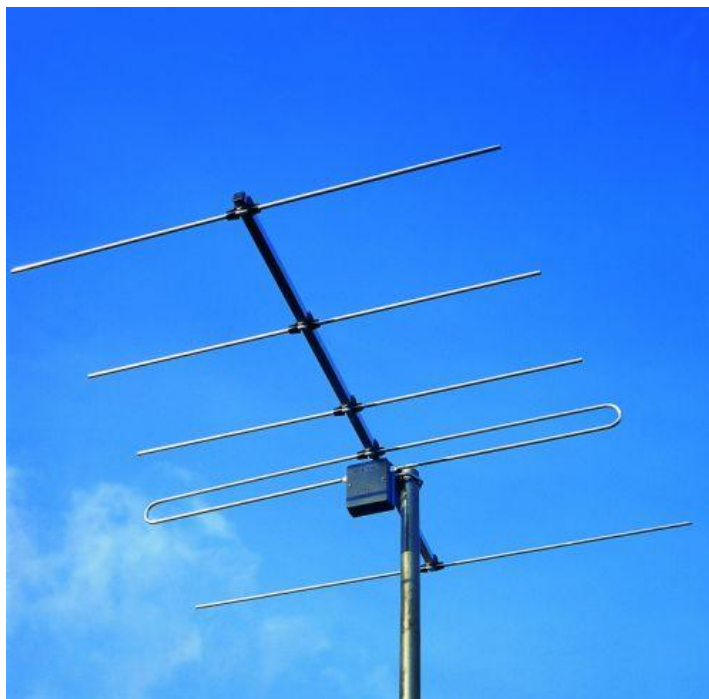
Obr. 7 - pětiprvková tv anténa, určená pro příjem ve III. tv pásmu, typ S0512, výrobce Kovoplast Chlumeck nad Cidlinou, se ziskem 5 dB
