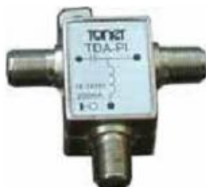
Obr. 21 - napájecí výhybka v provedení F konektor fy Toner. Šířka pásma 5 - 1000 MHz, vložný útlum < 1 dB, proudové zatížení max 200 mA DC.
