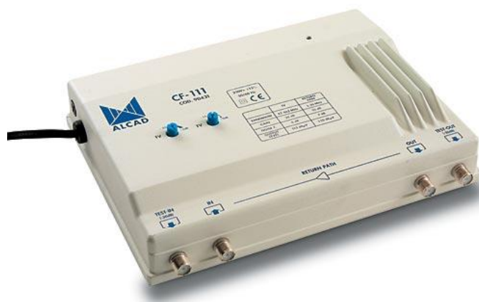
Obr. 54 – linkový zesilovač Alcad se zpětným kanálem a regulací zisku a náklonu.
