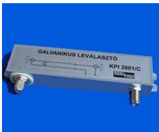
Obr. 42 - izolátor maďarské výroby firmy Kompat pro ss oddělení rozvodu. ( průchozí útlum pod 1 dB, tlumení odrazu lepší, než 18 dB, ss pevnost 2,5 kV )
