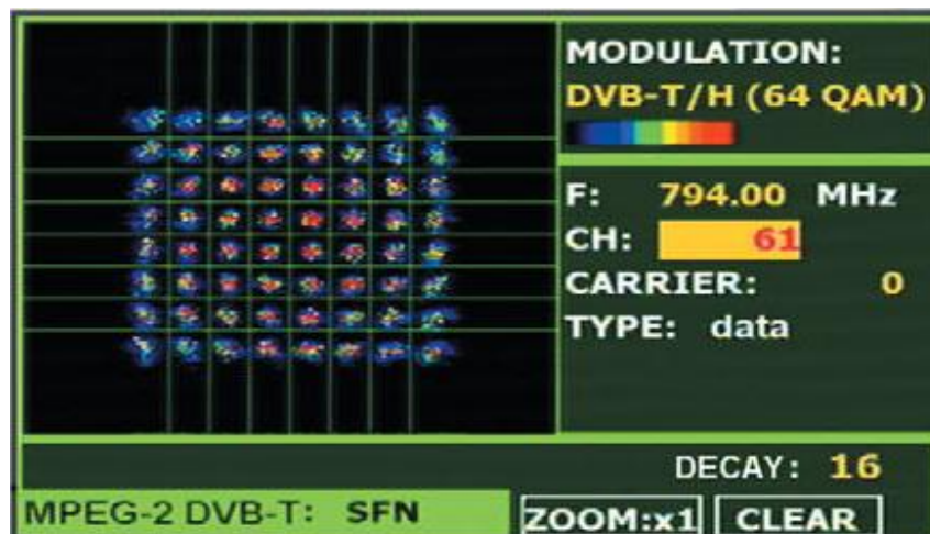
Obr. 14 - modulace 64-QAM jedné nosné v módu 8k COFDM pozemního příjmu DVB-T na 61 kanále se středním kmitočtem 794 MHz.
