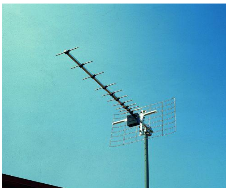
Obr. 9 - pásmová anténa pro kanály 21 - 65 tv pásma UHF s plochou reflektorovou stěnou (zahnuté okraje reflektorové stěny jsou z důvodu zlepšení ČZP), na obrázku 12-ti prvková anténa TAP 1260 firmy Kovoplast, se ziskem 6,5 - 11 dB, ČZP 20dB, horizontální úhel 61° - 31°, vertikální 88° - 33°.
