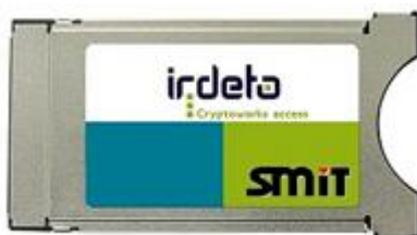
Obr. 24 – CA modul – dekodér Irdeto pro systém Cryptoworks
