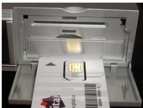
Obr. 23 – receiver s integrovaným dekodérem CW – slot pro dekódovací kartu
