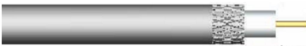
Obr. 12 – přehnutí opletení o vnější plášť kabelu.
