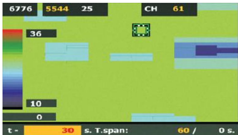
Obr. 17 – merogram na displeji přístroje Promax. Grafickým kurzorem můžeme posunovat po obrázku a zobrazit aktuální hodnotu MER a časovou značku kurzorem vybraného oddílu.
