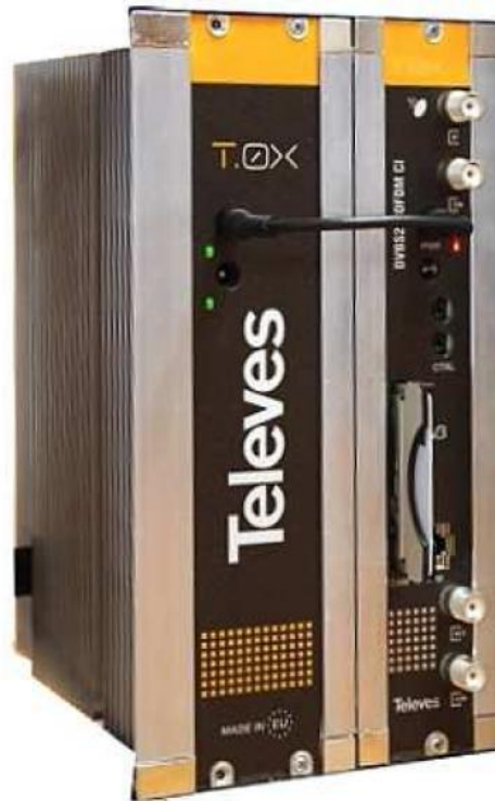
Obr. 60 – transmodulátor DVB-S/S2 do DVB-T typ 5633 firmy Televés s CI slotem pro dekodér scamblovaných satelitních programů. Programování a nastavení pomocí externího programátoru, připojitelného pomocí RJ-45 konektoru.
