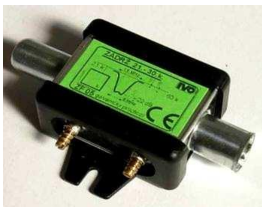
Obr. 28 - kanálová zádrž skupiny kanálů firmy IVO - anténní technika.
