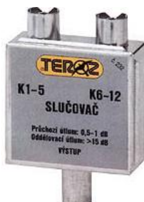
Obr. 31 - pásmový slučovač firmy Teroz Loštice pro sloučení pásem VHF I+II a VHF III. (průchozí útlum mezi jednotlivými vstupy a výstupem 0,5 dB)
