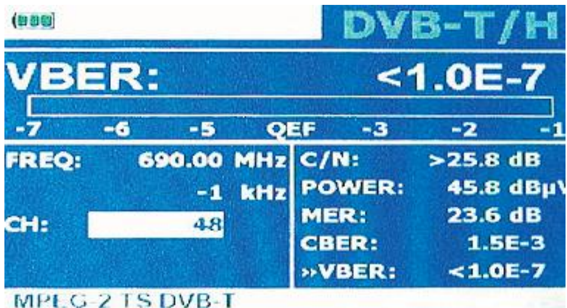
Obr. 6 – měření VBER přístrojem Promax.
