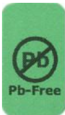
Obr. 8 - označení technologie bezolovnatého pájení na deskách plošných spojů.
