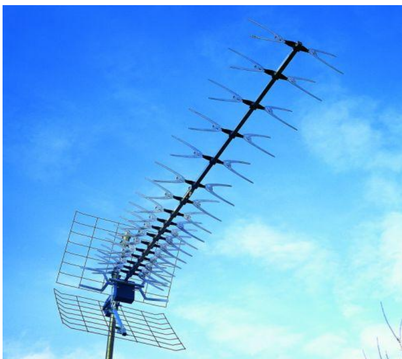
Obr. 10 - na obrázku anténa typu Color Super, skládající se z 91 prvků pro kanály 21 až 65 firmy Kovoplast, se ziskem 10-15 dB, ČZP 32 dB, horizontálním vyzařovacím úhlem 22,5°-44°, vertikálním 24°-49°.
