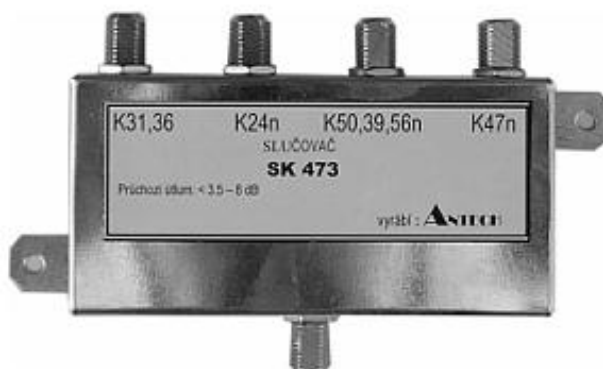
Obr. 33 - vícevstupový vícekanálový slučovač firmy Antech Břeclav. ( průchozí útlum menší jak 5 dB, selektivita při odstupu 3 kanálů lepší, jak 20 dB )
