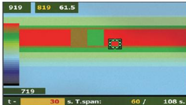
Obr. 19 - funkce spektrogramu na displeji analyzátoru Promax TV explorer II . Je zde vidět chvilkový pokles úrovně signálu a podobně jako u merogramu je i tady možné ponastavení kurzoru na toto místo obdržet přesné informace o tomto úseku (úrovni a čase).
