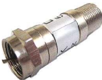
Obr. 43 - izolátor s nepřerušovanou zemí, sloužící pouze k oddělení napájení od rozvodu (například při připojení antén bez zesilovače k zesilovači hlavní stanice, napájecímu zároveň na svém vstupu případný předzesilovač bez možnosti vypnutí)
