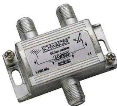
Obr. 34 - slučovač ASW800 firmy Schwaiger pro sloučení tv a satelitního (1 mf) signálu (tyto slučovače jsou DC propustné ve směru SAT vstup - výstup s horní propustí 950-2400 MHz v tomto směru a dolní propustí 5 - 862 MHz tv vstup).
