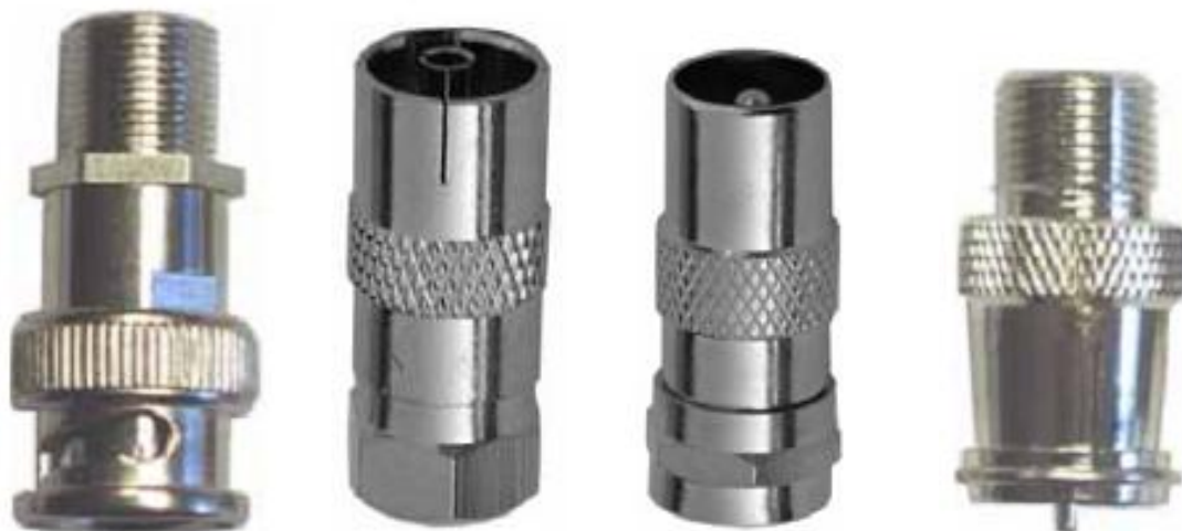
Obr. 18 - první zleva redukce BNC samec - F samice, druhý zleva F samec - IEC samice, třetí zleva F samec - IEC samec a poslední redukce je F samec rychloupínací (bez závitů) - F samice.
