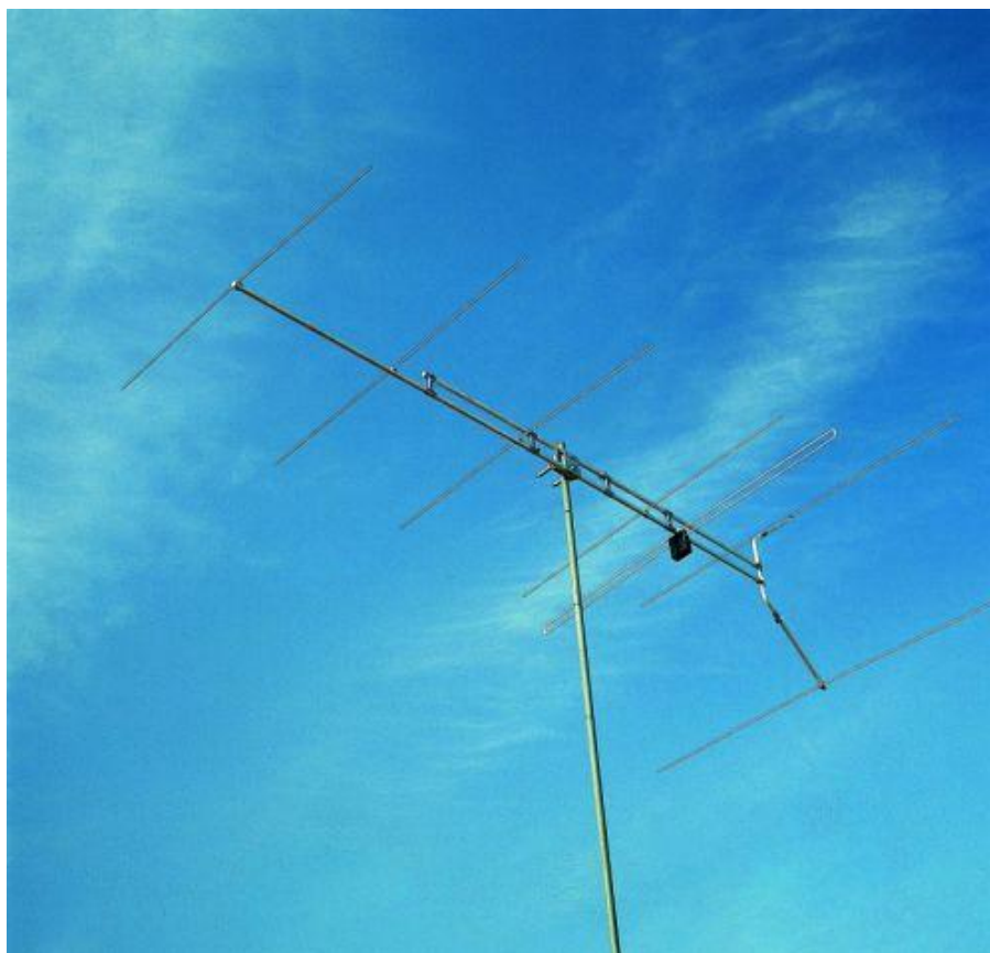
Obr. 5 - na obrázku je směrová sedmiprvková anténa typu Supersonic výrobce Kovoplast Chlumeck nad Cidlinou se ziskem 7,6 – 9,7 dB a s vyzařovacím úhlem vodorovně 59°-49°, svisle 78°-56°, ČZP (činitel zpětného příjmu) 20 dB.
