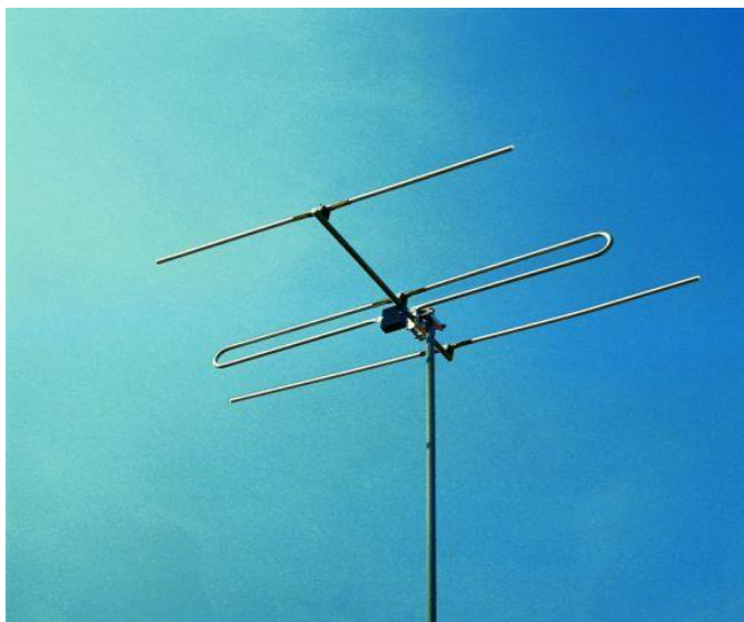
Obr. 6 - tříprvková anténa pro příjem v I. a II. tv pásmu výrobce Kovoplast Chlumeck nad Cidlinou, typ S0302 pro 2 kanál VHF I (zisk 5 dB, ČZP 12 dB, horizontální vyzař. úhel 68°, vertikální 130°) vpředu direktor, poté zářič - dipol a delší prvek – reflektor
