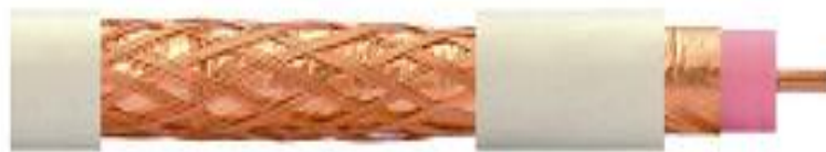
Obr. 5 - praktické provedení koaxiálního kabelu firmy Nordix typ Cablesat Milenium digital (útlum na frekvenci 862 MHz 14,7 dB, na frekvenci 2,15 GHz 24,8 dB, PVC plášť v provedení s ochrannou UV vrstvou - venkovní provedení, vnitřní provedení HFLS - nehořlavý, 15 let garance parametrů)
