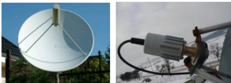
Obr. 7 - vlevo středová parabolická anténa, vpravo detail vnější jednotky s ozařovačem.
