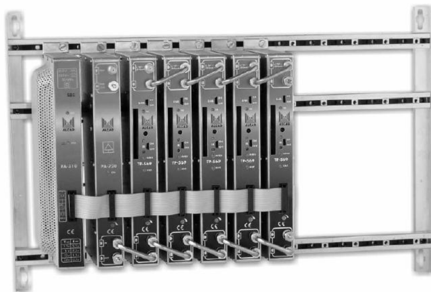
Obr. 49 - digitální skupinový satelitní přijímač TP-569 s CI sloty pro dekodéry kódovaných programů. Verze TP-551 nemá CI sloty a je určena pouze pro příjem volných programů. Výstupy jsou po nasmyčkování na požadovanou úroveň zesíleny širokopásmovým zesilovačem.
