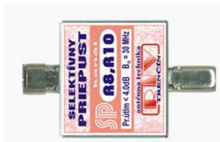
Obr. 25 - selektivní dvoukanálová propust firmy RTV Trenčín. ( průchozí útlum 4 dB, oddělovací útlum 20 dB )
