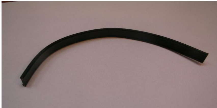
Obr. 3 - VHF dvojlinka PLE 300-8 (VFSP-510) pro pásmo VHF (útlum 30 dB/1 GHz)
