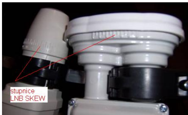
Obr. 31 – stupnice SKEW u single konvertoru a monobloku
