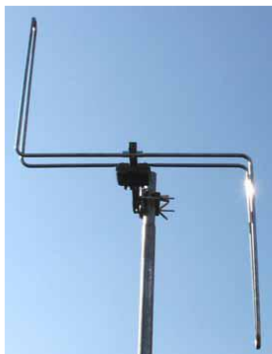
Obr. 4 – vlevo kruhový dipol CIRCUL pro pásmo FM II firmy Kovoplast Chlumeck nad Cidlinou, vpravo lomený typ všesměrové FM antény typ FM-200 firmy Alcad.
