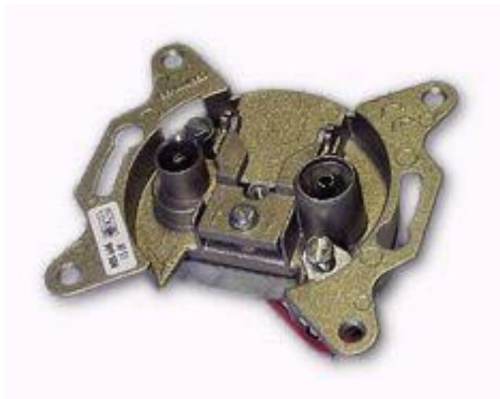
Obr. 48 - průchozí účastnická zásuvka RDS-646 firmy Schwaiger. ( typ RDS 646 - 15 s vazebním útlumem mezi vstupem a tv výstupem 15 db, průchozí útlum 2,5 dB )
