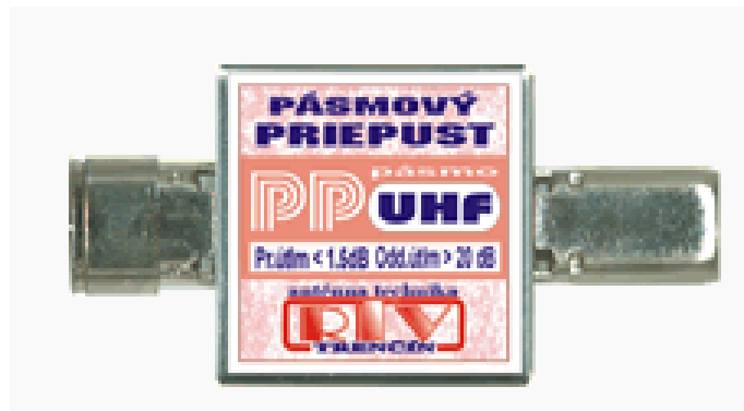
Obr. 39 - pásmová propust UHF pásma firmy RTV Trenčín. ( průchozí útlum 0,5 - 1,5 dB, oddělovací útlum - potlačení pásma VHF lepší jak 25 dB )
