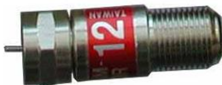
Obr. 12 - fixní útlumový článek FAM frekv. rozsah 5 - 1000 MHz, přesnost +/- 0,5 dB, výrobce vyrábí 7 různých hodnot fixního útlumu, články nejsou průchozí pro napájení.
