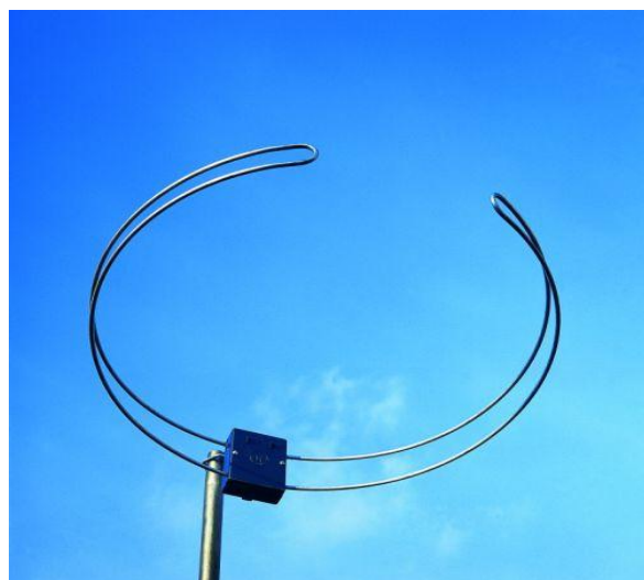
Obr. 4 – vlevo kruhový dipol CIRCUL pro pásmo FM II firmy Kovoplast Chlumeck nad Cidlinou, vpravo lomený typ všesměrové FM antény typ FM-200 firmy Alcad.
