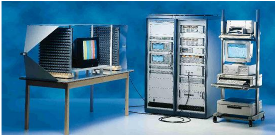
Obr. 7 - mobilní souprava pro provádění testů EMC firmy Rohde&Schwarz.
