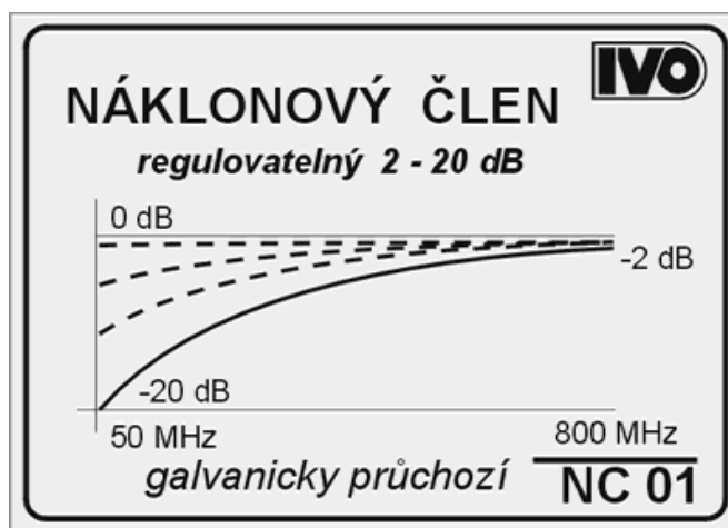
Obr. 20 - štítek náklonového členu firmy IVO - přijímací technika pro názornost jeho funkce.
