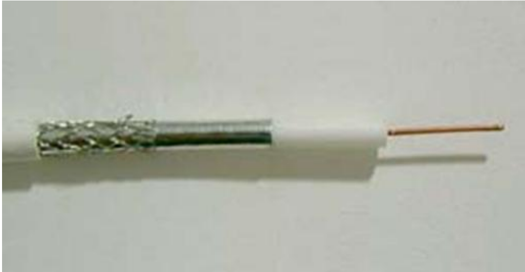
Obr. 6 - provedení kabelu firmy Belden typ H-125 Al PE, homologovaného pro STA, útlum 19,1 dB/100 m (860 MHz), tlumení stíněním > 85 dB, varianta vnějšího pláště PE vhodná pro zemní uložení a vystavení extrémním povětrnostním vlivům - hořlavé, varianta PVC pro vnitřní rozvody - nehořlavé samozhášivé provedení.
