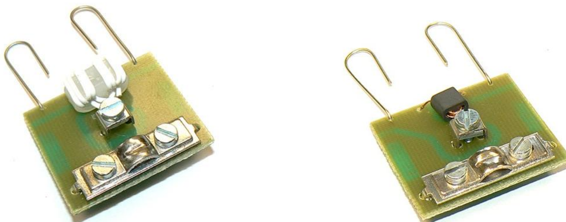
Obr. 2 - symetrizační/transformační člen v provedení pro montáž do anténní krabičky vlevo pro pásmo UHF, vpravo pro pásmo VHF, liší se provedením transformátoru a materiálem jádra - mosten pro UHF a ferit pro VHF.
