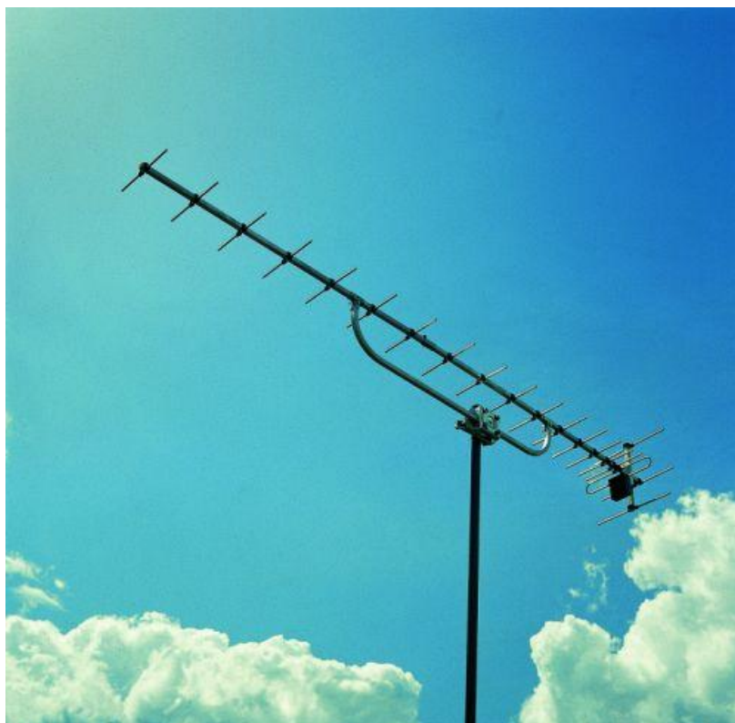
Obr. 8 - vícekanálová anténa pro pásmo UHF. Na obrázku dvacetiprvková anténa S2026 GL firmy Kovoplast pro 21 - 26 kanál pásma UHF (zisk 13 dB, ČZP 24 dB, horizontální vyzař. úhel 29° - 33°, vertikální 31° - 35°).
