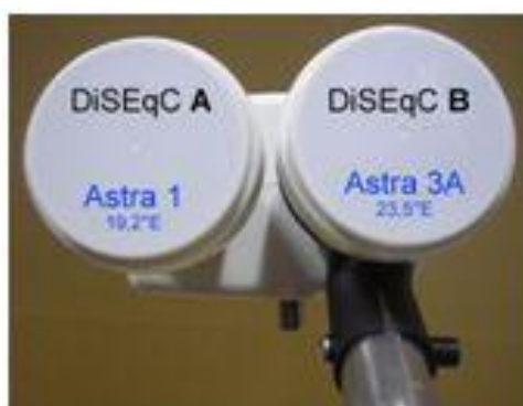
Obr. 47 - monoblok, umístěný v držáku.
