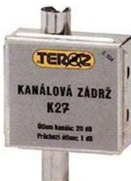
Obr. 27 - kanálová zádrž firmy Teroz Loštice pro potlačení jednoho tv kanálu. ( útlum zadržovaného kanálu 20 dB při šíři kanálu 8 MHz, průchozí útlum 1 dB )
