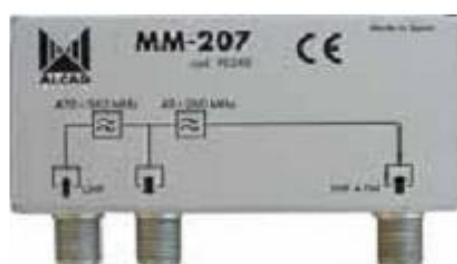
Obr. 30 - pásmový slučovač MM-207 firmy Alcad pro sloučení signálů pásem VHF a UHF. (útlum mezi vstupem VHF a výstupem 0,5 dB, mezi UHF a výstupem 0,6 dB, izolace mezi vstupy větší než 30 dB)
