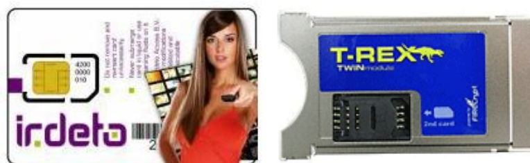
Obr. 28 – dekódovací karta s možností úpravy do velikosti SIM karty a CA modul se slotem pro tuto velikost
