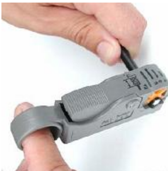
Obr. 10 – použití ořezávačky pro odstranění izolace kabelu.
