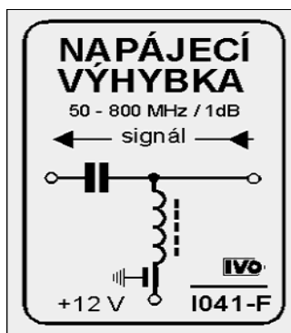
Obr. 23 - funkce napájecí výhybky a její vnitřní zapojení je patrná ze štítku výrobku firmy IVO
