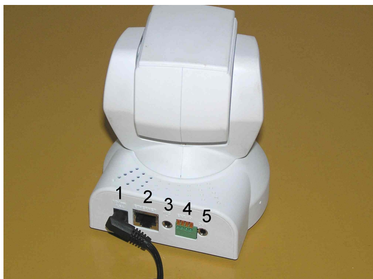
Obrázek č. 39 - popis konektorů pro připojení kamery
