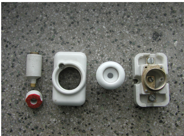
Obr.60: rozložený pojistkový komplet (pro montáž na základovou desku)
