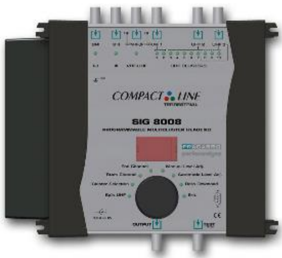
Programovatelný zesilovač Fracarro SIG8008 (vlevo - foto Fracarro) a Johansson Profino 6610
