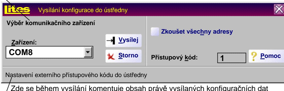
Vlastní nahrávání konfigurace do ústředny Firexa se provádí v nabídce **Komunikace**, **Vysílání**. Objeví se následující dialogové okno:
