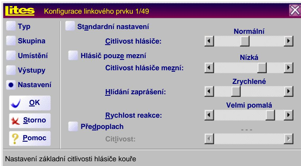
**Citlivost hlásiče** - lze nastavit v osmi stupních (velmi vysoká, vysoká, zvýšená, normální, snížená nízká, velmi nízká, minimální). Jde o změnu odpovědi fyzikální části hlásiče oproti jejímu ustálenému stavu, která vyvolá poplachovou odpověď (aktivaci) hlásiče. Jednotlivé citlivosti se vybírají posouváním jezdce na posuvníku, nastavená citlivost je vypsána nad posuvníkem.
